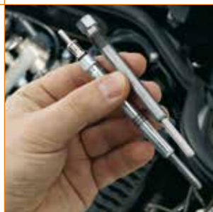
Το γλύφano της BERU – (RA003 – 0 890 100 003) καθαρίζει τις εναποθέσεις που ενδέχεται να παρατηρηθούν μετά το „ψήσιμο“ μεταξύ του προθερμαντήρα και της κυλινδροκεφαλής.
