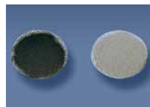
Εναποθέσεις άνθρακα σε χαρτί φίλτρου τρία λεπτά μετά την κρύα εκκίνηση. Με τη μεταθέρμανση (δεξιά), οι εναποθέσεις άνθρακα είναι περίπου 40% λιγότερες από ό,τι χωρίς τη μεταθέρμανση.
