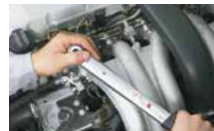
Τοποθετείτε και αφαιρείτε τους προθερμαντήρες ΜΟΝΟ με τη χρήση δυναμόκλειδου.
